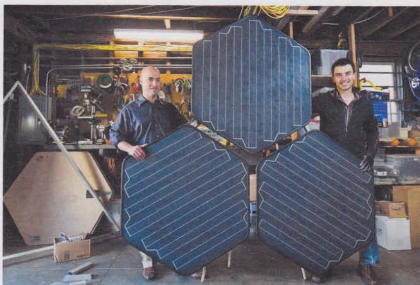
Mark Goldman (a sinistra) e Dmitry Dimov mostrano, nel loro laboratorio allestito in un garage, un prototipo del «Trifoglio fotovoltaico»: un elemento come questo peserebbe appena 37 chilogrammi.
